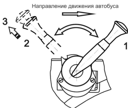
Рис. 2-7 Кран стояночного тормоза
